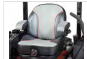
Asiento de suspensión premium de respaldo medio. Asiento con suspensión ajustable, reposabrazos acolchados y regulable hacia adelante y hacia atrás.
