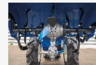
AZADA DE 55 CM Con contra-rotación de las fresas
