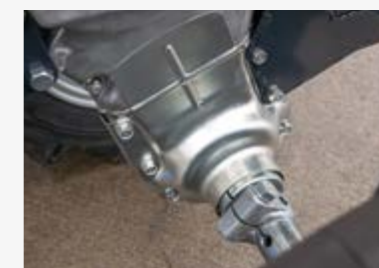
REFUERZO DEL PUENTE
